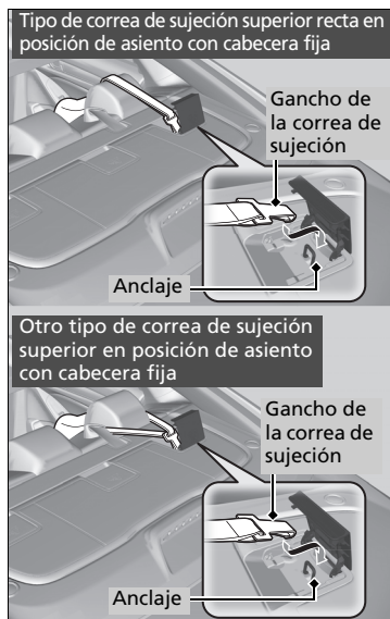
Tipo de correa de sujeción superior recta en posición de asiento con cabecera fija
